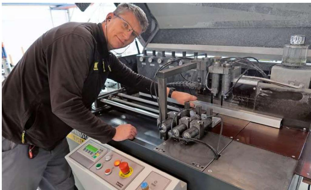
Mitarbeiter Dirk Herzberg steht an der Stanzmaschine, die eine Presskraft von 40 Tonnen hat.
